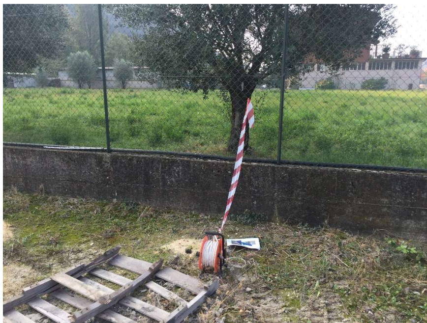
Ubicazione prova penetrometrica P-01 (Pz) realizzata all'interno del piazzale (Lato sud) di stoccaggio materiali di proprietà della Dante Brignoli Granulati S.r.l.. Installazione di un tubo piezometrico.
