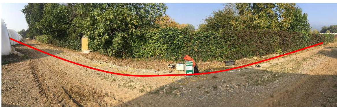
Strumentazione utilizzata per l'indagine Geoelettrica ERT e panoramica dello stendimento (GE-03).
